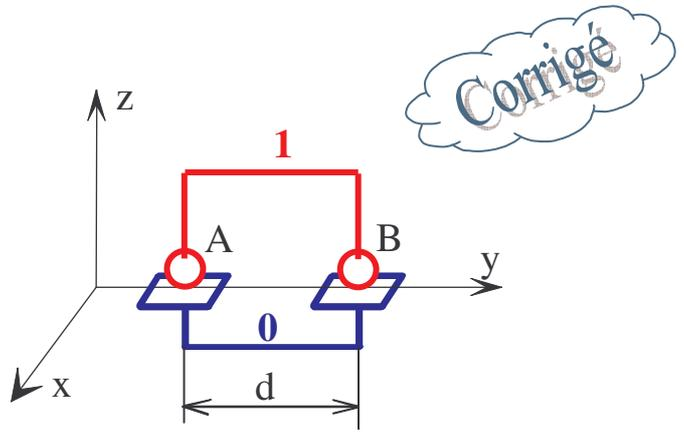
$$\overline{\mathcal{M}}_{AB0 \rightarrow 1} = \overline{\mathcal{M}}_{B0 \rightarrow 1} + \overline{AB} \wedge \overline{\mathcal{R}}_{B0 \rightarrow 1} = \vec{0} + d\vec{y} \wedge Z_B\vec{z} = dZ_B\vec{x}$$
