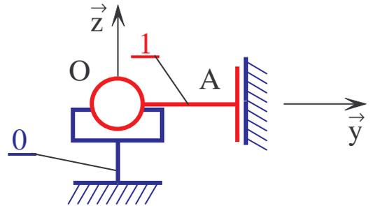
Appui plan de normale  $\vec{y}$  :  $\{A0 \rightarrow 1\} = \begin{Bmatrix} 0 & L_A \\ Y_A & 0 \\ 0 & N_A \end{Bmatrix}_{A, \vec{x}, \vec{y}, \vec{z}}$  Linéaire annulaire de centre O d'axe  $(O, \vec{y})$   $\{O0 \rightarrow 1\} = \begin{Bmatrix} X_O & 0 \\ 0 & 0 \\ Z_O & 0 \end{Bmatrix}_{O, \vec{x}, \vec{y}, \vec{z}}$
