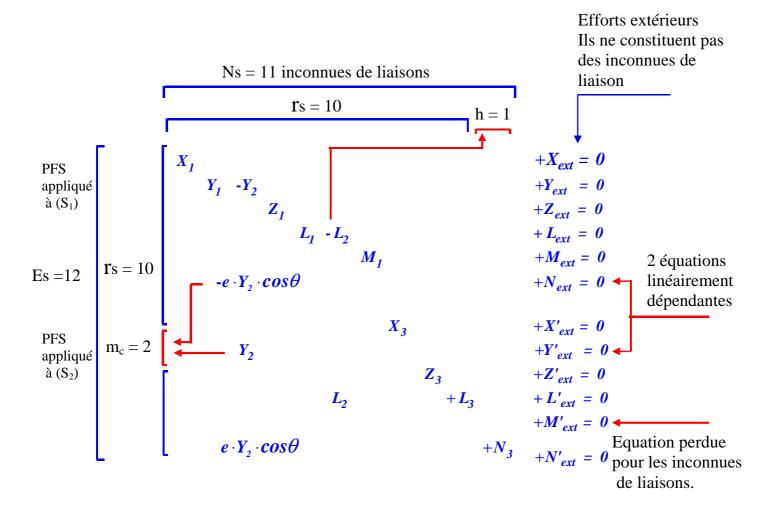
Q9 Y-a-t-il des équations de perdues ? On perd deux équations  $\Rightarrow$   $r_s = 12 - 2 \Rightarrow r_s = 10$
