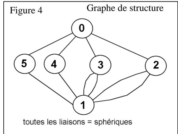
**1- liaison équivalente entre (1) et (0) réalisée par la biellette (4) :**
