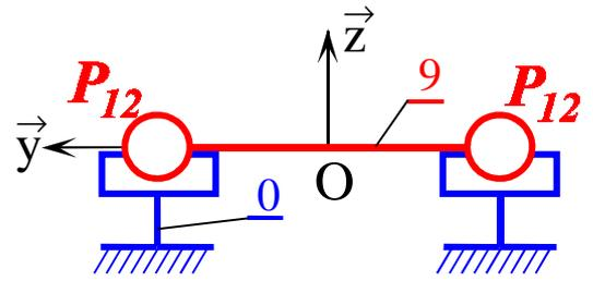
On obtient une liaison pivot glissant d'axe  $(P_{12}, \vec{y})$
