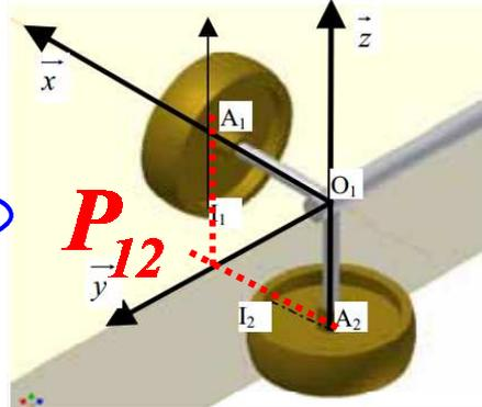
Rem : On voit que les deux torseurs peuvent être définis au même point  $P_1$  intersection des normales des deux ponctuelles en  $I_1$  et  $I_2$ .
