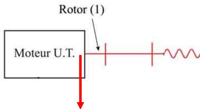
pivot de coefficient de frottement visqueux  $f_1$
