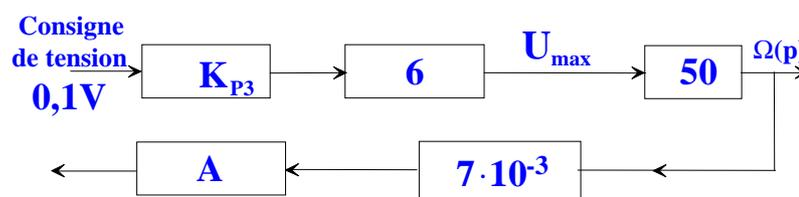
d'où  $U_{max} = 30\text{V} = 0,1 \times K_{P3} \times 6 \Rightarrow K_{P3} = \frac{30\text{V}}{0,1 \times 6} = 50 \Rightarrow K_{P3} = 34\text{dB}$
