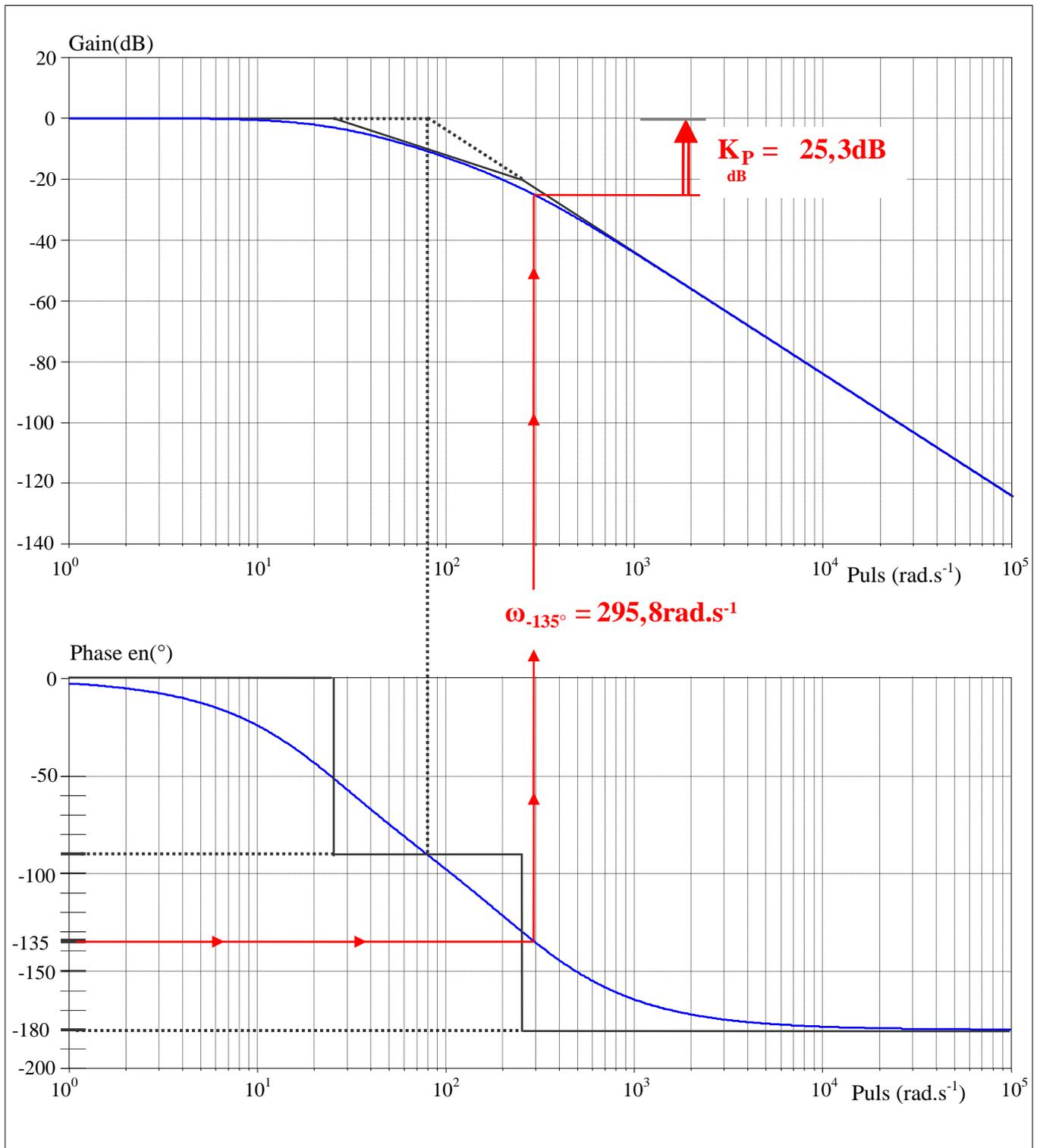
5- Correction proportionnelle :  $C_1(p) = K_{P1}$ . Déterminer le gain  $K_{P1}$  pour obtenir une marge de phase de  $45^\circ$ . (Cette valeur  $K_{P1}$  constitue un pré réglage)
