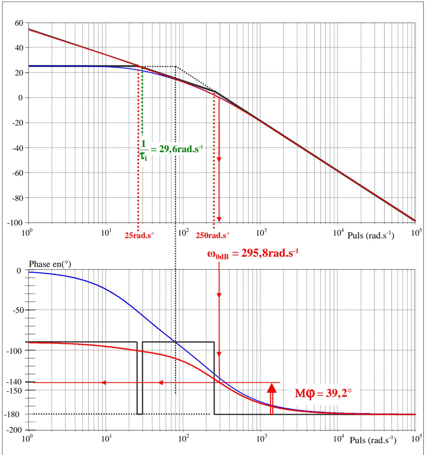
On peut réaliser la mise en place du correcteur intégral en plaçant sa cassure une décade avant la valeur obtenue pour  $\omega_{0dB}$ . On sait qu'on perdra  $5^\circ$  de marge de phase.
