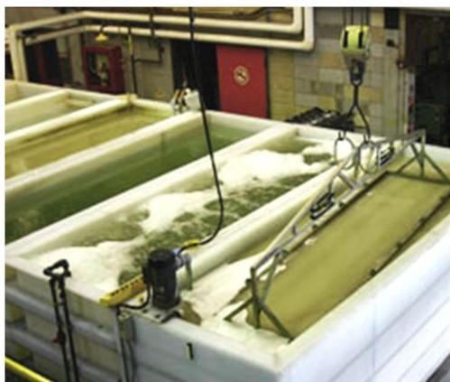
On s'intéresse à un poste de dégraissage d'une machine de traitement de surface dont on donne une description matérielle ainsi qu'un extrait de cahier des charges ci-dessous.
